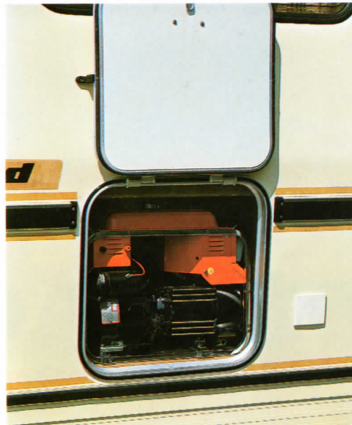
220 V Notstromaggregat herausziehbar und geräuscharm gekapselt.
