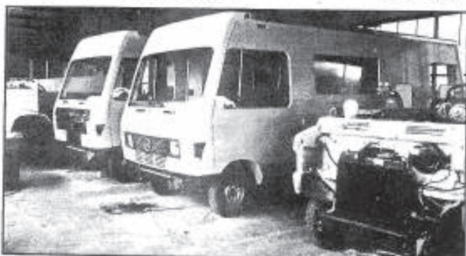
Hier werden die Karossen auf die vorbereiteten Fahrgestelle montiert.
