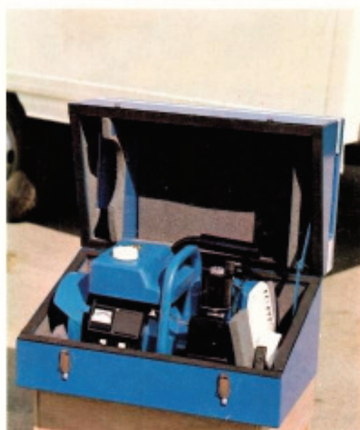
220 V Notstromaggregat herausziehbar und geräuscharm gekapselt.
