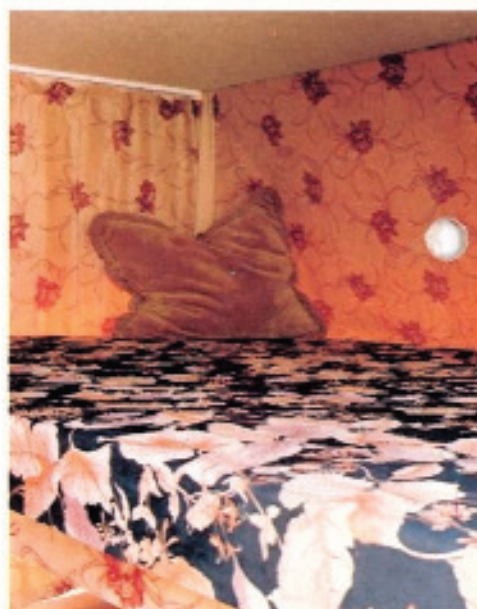
senkbares Doppelbett im Fahrerhausbereich mit dem Vorteil des weiteren Stauraums während der Fahrt.
