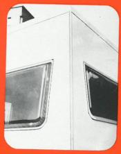
Serienmäßig werden eingefärbte Doppelfenster montiert
