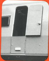
Ganz besonders wurde bei der Konstruktion der Mobile auf einen hohen und bequemen Fahrerhausdurchgang Wert gelegt, denn das Fahrerhaus soll weitgehendst integriert zum Wohnraum sein, trotzdem soll eine gewisse Abtrennung vorhanden sein.
