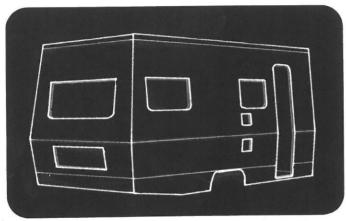
Der Mobilaufbau ist eine allseitig hermetisch abgeschlossene Karosserie, die absolut verwindungsstabil und selbsttragend ist. Sie wird als ganze Einheit auf das Fahrzeuggestell aufgesetzt, und mit dem Fahrerhaus entsprechend verbunden.
