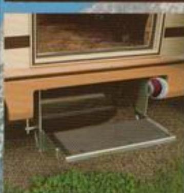
Fenster in kaltebrückenfreier PU-Bauweise mit Doppelverglasung und im Wohnraumbereich.
