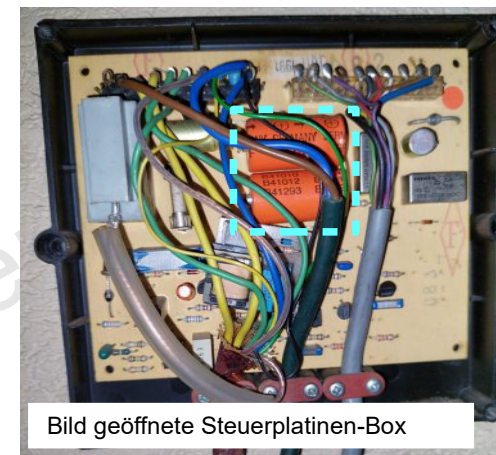
Rückseite Platine Bedienteil; re krit. Reparatur!
